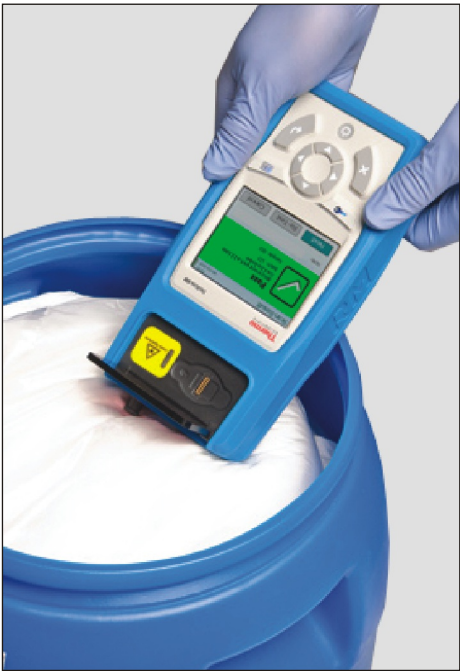
分析仪可透过密封包装检验物料，降低了污染和暴露风险。
